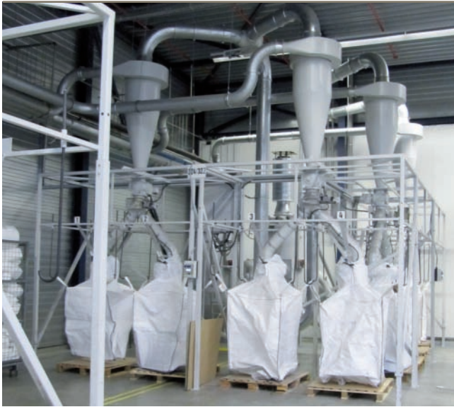
图4：Getecha可提供大袋装袋站，支架的高度可调节，可悬挂一个或两个大袋，气动开关可手动或自动。
