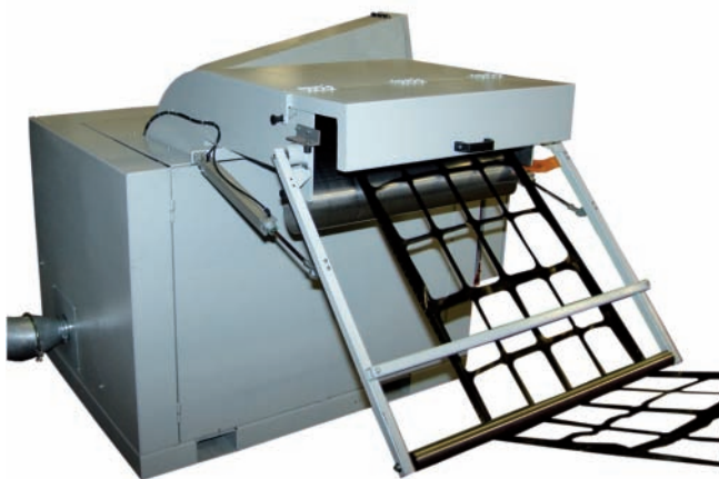
图2: RS 3000系列配备了三刀旋转切割器(切割圆直径300mm),吞吐量高达1000 kg/h,图片为RS 3009
