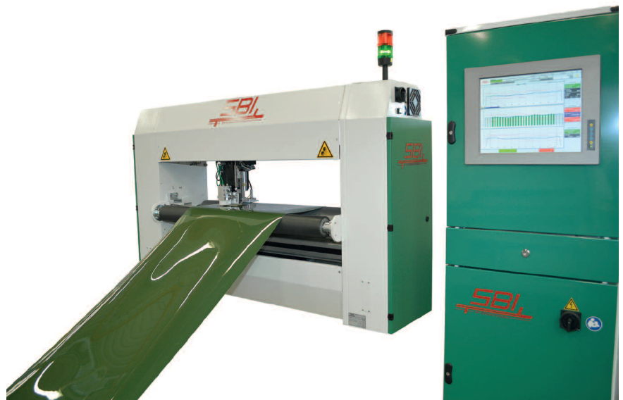
KAPA-IR厚度测量装置，用于探测EVOH阻隔层
