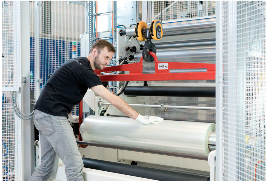
1.25米宽的薄膜基材放置在atmoFlex 1250辊到辊涂覆生产线上 (© Fraunhofer FEP)
