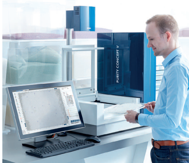
PURITY CONCEPT V 是用于塑料材料的离线检测与分析的自动样品台
