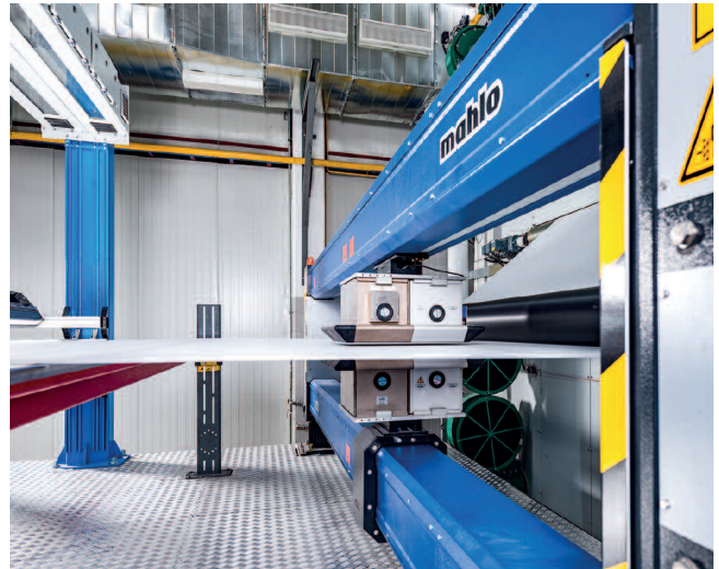
Qualiscan QMS配备两个横移传感器 (© 2021 Mahlo GmbH + Co. KG)
