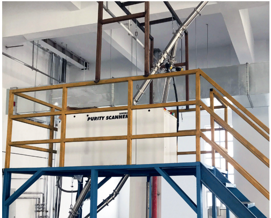
SIKORA的先进的纯度扫描仪安装在一家中国高压、超高压和海底电缆制造商的设备上, 用于对交联聚乙烯粒子进行检查和分类
