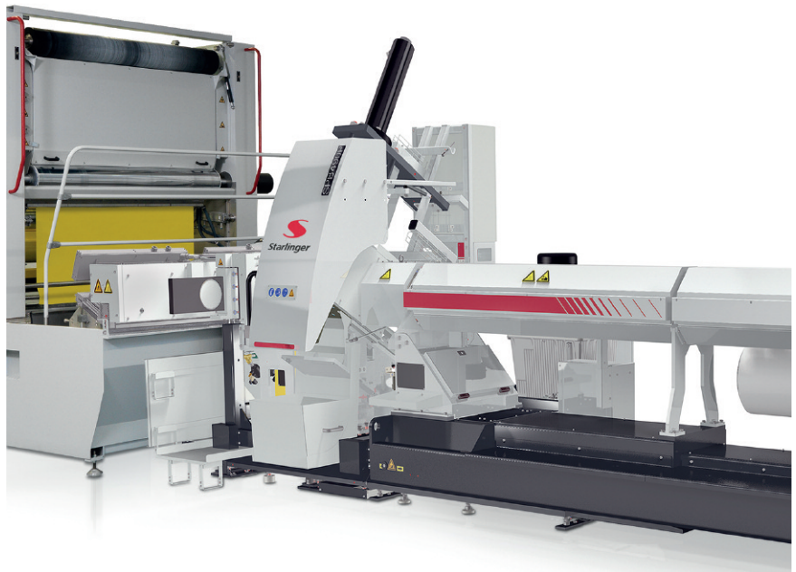
Starlinger SPB Filter_300dpi.jpg: 史太林格公司生产的单活塞反冲洗过滤器，用于扁丝生产中的再生聚丙烯
