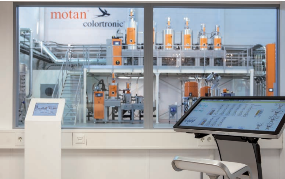
Anlagen und Geräte für das Materialhandling, einschließlich übergeordneter Steuerungen sowie Systeme für die Visualisierung der verschiedenen Anlagen
