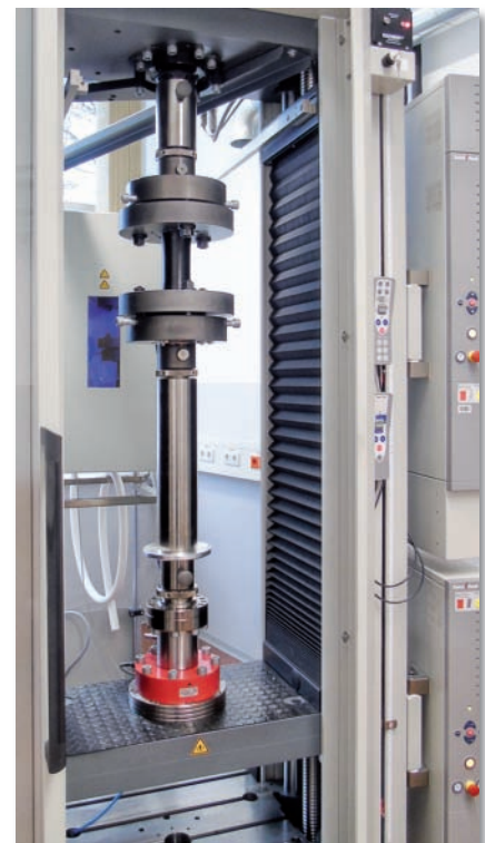
Prüfung von CFK-Rohren
