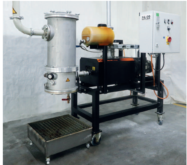
Bild 1: Eines von insgesamt sieben Plastex Entgasungssystemen bei PolyComp. Sie sind jeweils ein Stockwerk über den Extrudern aufgestellt (Foto: Busch)
