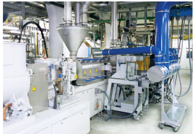
Bild 3: Die beiden Seitendosierungen am Doppelschneckenextruder. Ein Plastex Entgasungssystem sorgt für eine Volumenreduzierung bei der Füllstoffzufuhr (Foto: PolyComp)
