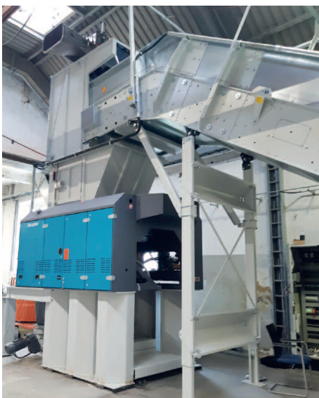
Der neue Zerkleinerer V-ECO 1300 von Vecoplan im Einsatz bei RKW: Zukünftig sollen Folienabfälle in ein homogenes Output-Material verwandelt werden
