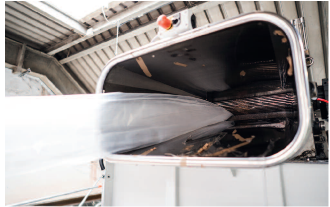
Oben am Trichter ist ein Rolleneinzug angebracht, der aufgewickelten Produktionsausschuss von der Rolle in den Zerkleinerungsraum zieht
