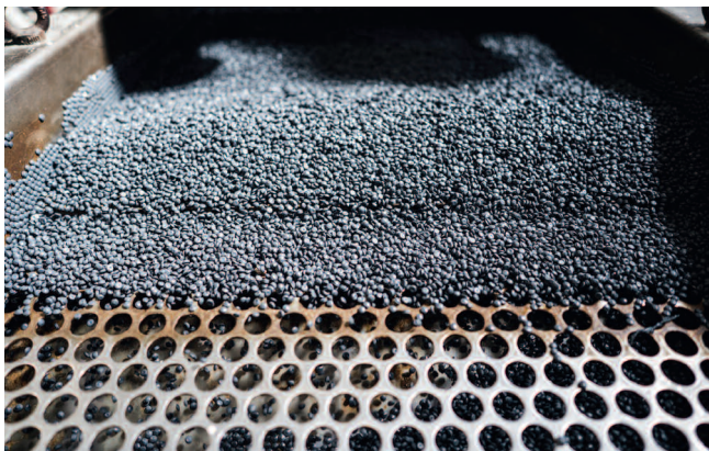
Mit dem Extruder wird hochwertiges Reggranulat erzeugt
