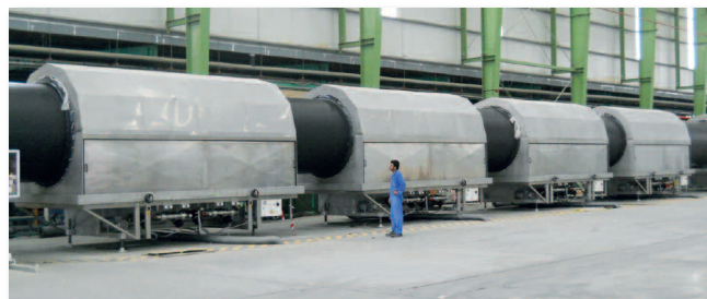
Bild 1: Beispiel PE-Großrohrlinie (oben), zeitliche Entwicklung des maximal herstellbaren Außendurchmessers von Vollwandrohren (unten)
