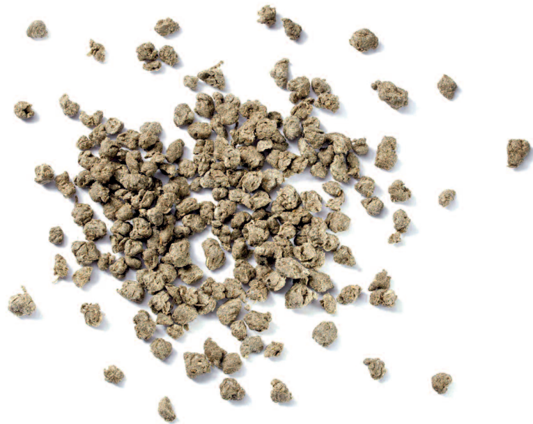
Das Öko-Granulat AgriPlast ist ein innovativer Verbundwerkstoff aus 75 Prozent Grasfaser-Zellulose und 25 Prozent recyceltem Polypropylen oder Polyethylen (Bild: Biowert)
