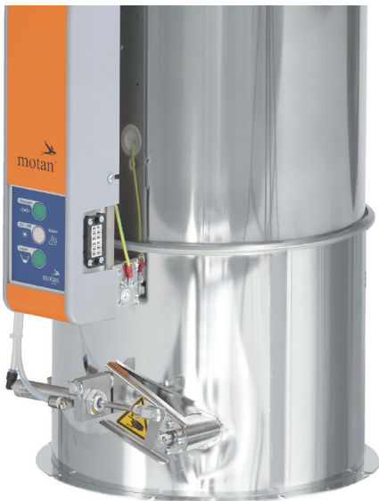
Fördergerät mit gesteuerter Klappe
