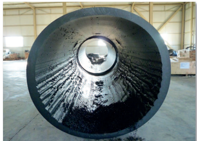
Bild 3: Prinzipdarstellung des Saggingeffekts (links), Beispielrohr mit Sagging 2000 x 95,6 mm (rechts)
