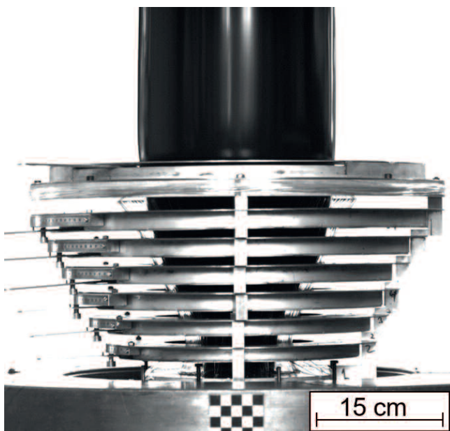
Bild 5: Dritter Prototyp einer flexiblen LFE: Die Verstellung der luftführenden Membran erfolgt
