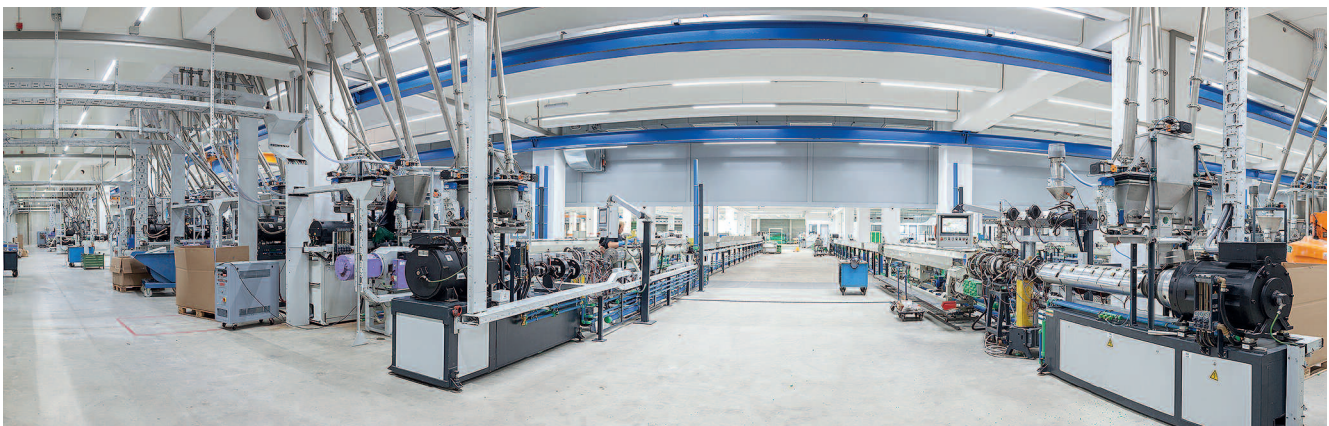
Bild 3: Extrusionshalle: aquatherm stellt verschiedene PP-R-Rohre mit Durchmessern von 16 bis 630 Millimetern her (Bild: aquatherm)
