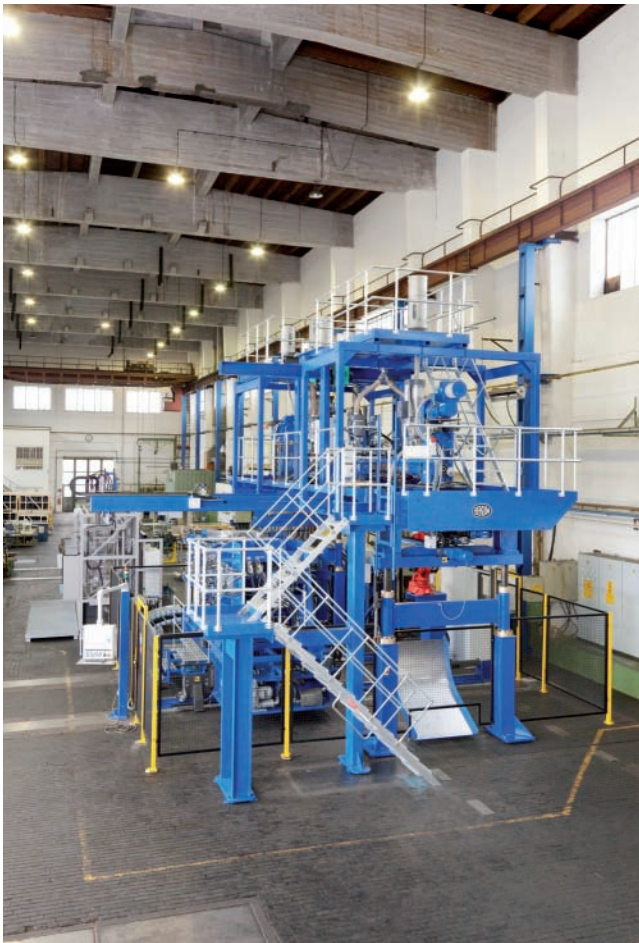
Großanlagenbau in Traismauer: Endmontage einer 6-Layer-Tanksystem-Blasmaschine BA 220 M Coex für Automotive in Traismauer
