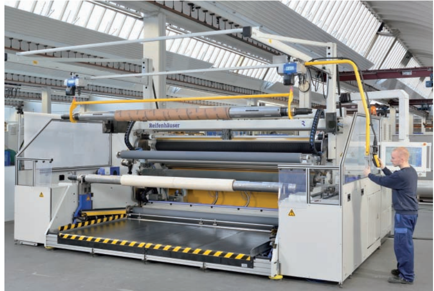
Mit dem von Reifenhäuser Cast Sheet Coating neu konzipierten Horizontal-Schiebewickler der Baureihe MIDEX-HSD lassen sich Rollendurchmesser bis 1200 mm problemlos realisieren (Foto: Reifenhäuser)
