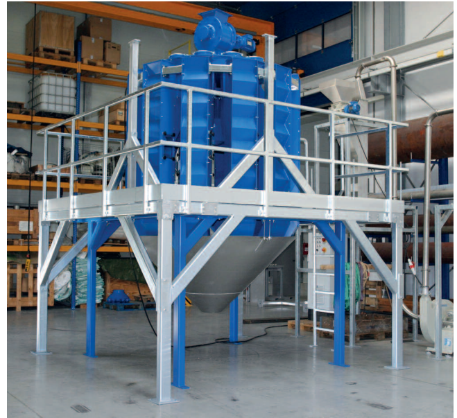
Im Zick-Zack-Sichter trennt ein Luftstrom unterschiedliche Kunststoffteile entsprechend ihren Schüttgewicht. Leichte Kunststoffe werden nach oben abgesaugt, schweres Mahlgut fällt nach unten
