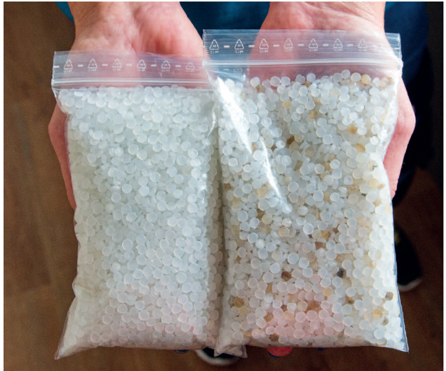
Rechts eine Probe des verunreinigten Granulats vor dem Sortierprozess, links dasselbe Material nach dem Sortierprozess (Alle Bilder: ©Sortco GmbH & Co. KG)
