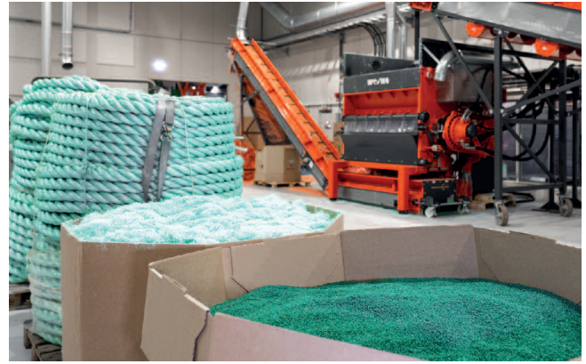
WEIMA W5.22 Einwellen-Zerkleinerer für Kunststoffe aller Art
