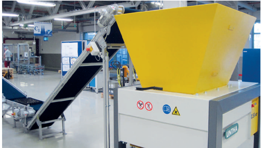
Der Vorteil des langsam laufenden Zerkleinerungssystems ist die geringe Lärm- und Staubentwicklung (© UNTHA shredding technology)
