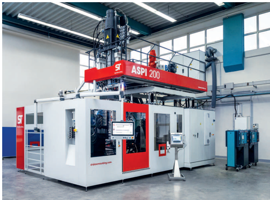
Die ASPI 200 eignet sich sowohl für das Saugblasen (3D) als auch für konventionelles Blasformen (2D)
