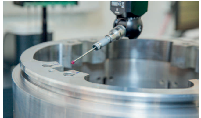
Taktile Vermessung eines Rotationskörpers bei der Lometec GmbH & Co.KG
