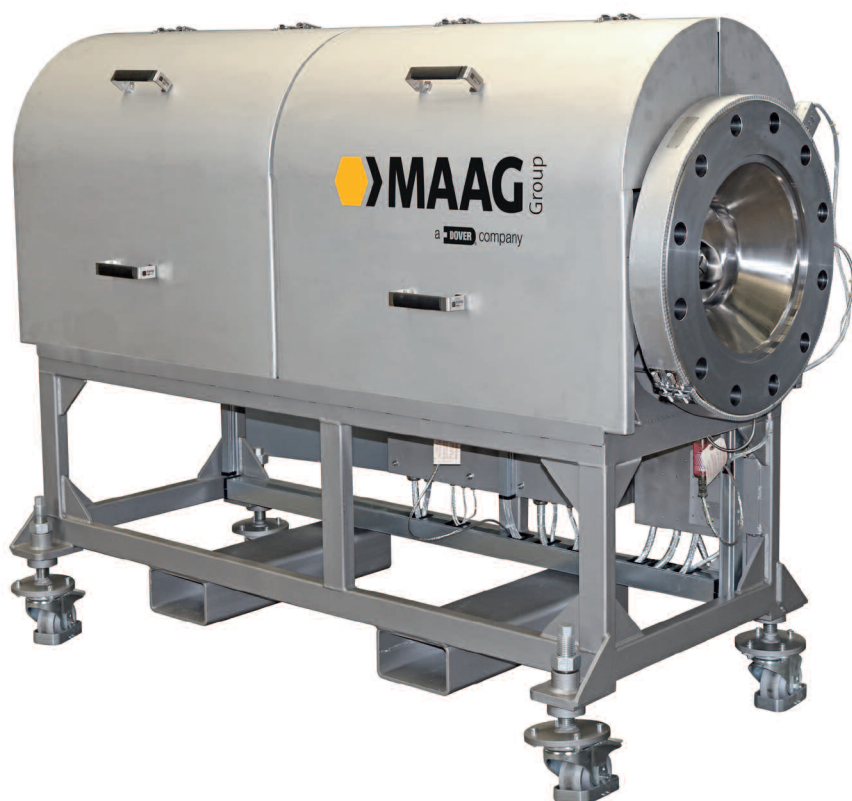
Bild 3: Die von Maag gelieferte integrierte Einheit besteht aus dem Filter SFS-3-3000 und der nachgeschalteten, kundenseitig bereitgestellten Kühleinheit (linke Seite) (© Maag)
