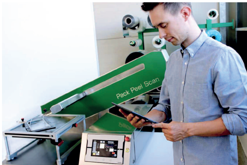
"Pack Peel Scan" überprüft normgerecht die Öffnungskräfte thermogeformter, peelbarer Verpackungen. Die maschinelle Lernmethode ermöglicht zusätzlich die Prognose und Vermeidung von Prozessfehlern (© Fraunhofer IVV)
