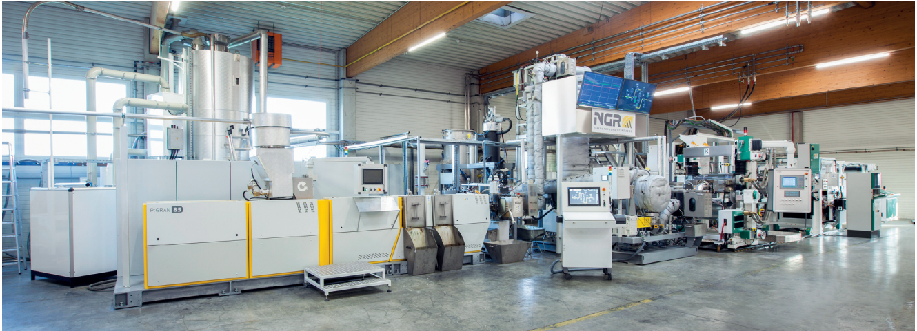
Mit der LSP Technologie verarbeitet die NGR Recyclinganlage rPET Sheet Flakes direkt zu lebensmitteltauglicher KUHNE Folie (Bild: NGR)
