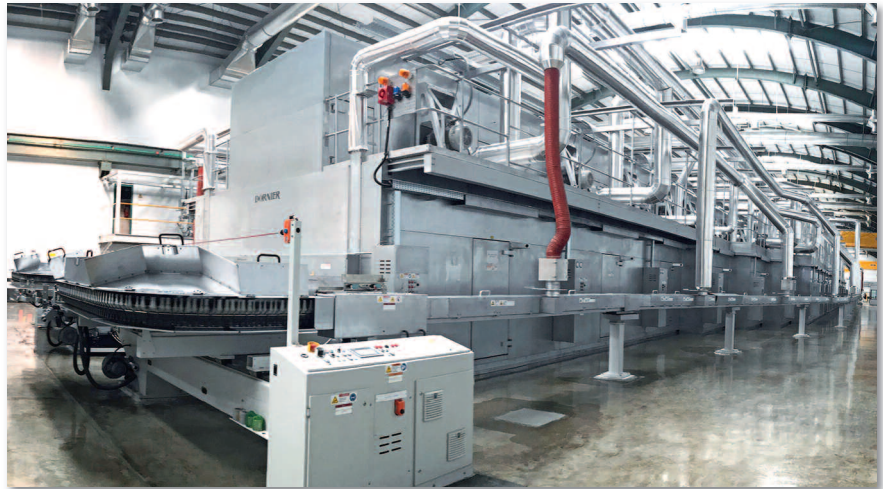
Bis zu 35 Prozent Wärmeenergie einsparen: Mit der verbesserten Luftführung bei TDOs von DORNIER lässt sich die Energieeffizienz deutlich steigern (Bildquelle: DORNIER)
