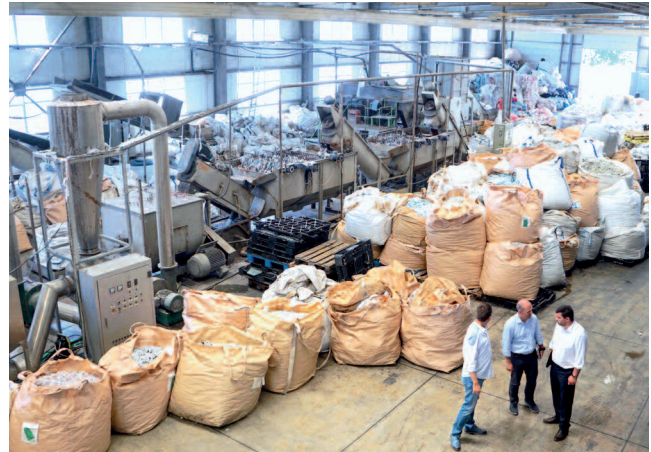
Bild 4: Eine penible Materialaufbereitung durch Shreddern, Waschen und Trocknen schafft die Ausgangsbasis für die Kaskada-Qualitätsgranulate. Dafür sind mehrere Aufbereitungslinien in Betrieb
