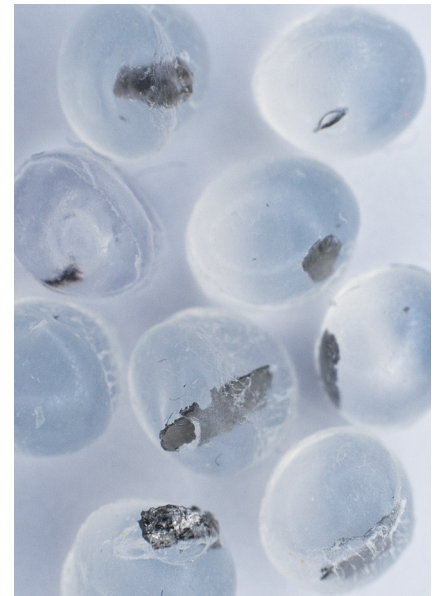
Bild 1: Metalleinschlüsse im Kunststoffgranulat, verursacht durch eine Beschädigung des Extruders bei der Materialherstellung
