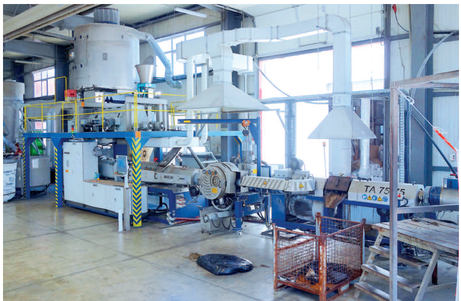
Bild 5: Die aufbereiteten Folienflakes werden von der Waschanlage vorgetrocknet der MAS-Kaskaden Extrusionsanlage, bestehend aus konischem Doppelschneckenextruder, Filter und Einschnecken-Entgasungs-Extruder zugeführt
